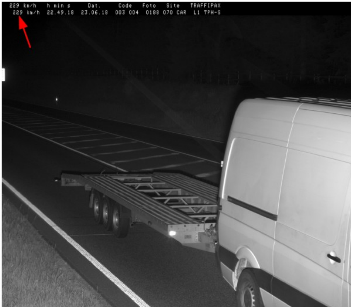
Abbildung 12: Messfoto (Bild 0188) mit offensichtlich falschem Messwert
